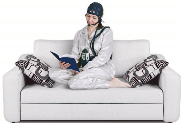
Рис. 9. Компактный автономный регистратор крепится непосредственно на теле обследуемого и оснащен беспроводным интерфейсом для передачи данных в компьютер Fig. 9. The compact stand-alone recorder is mounted directly on the patient's body and is equipped with a wireless interface for transferring data to a computer
