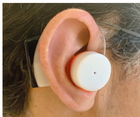
Рис. 9. Сенсор, встроенный в ушное устройство Fig. 9. Sensor integrated in hearing aids
