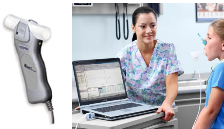
Рисунок 3.14. Цифровой спирометр с телемедицинскими функциями, цифровая спирометрия 37
