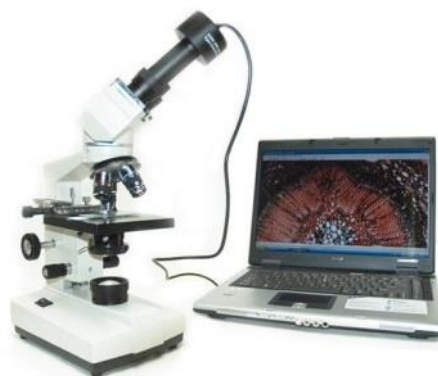
Рисунок 17.1. Система для статической телепатологии (микроскоп со специальной камерой) 322
