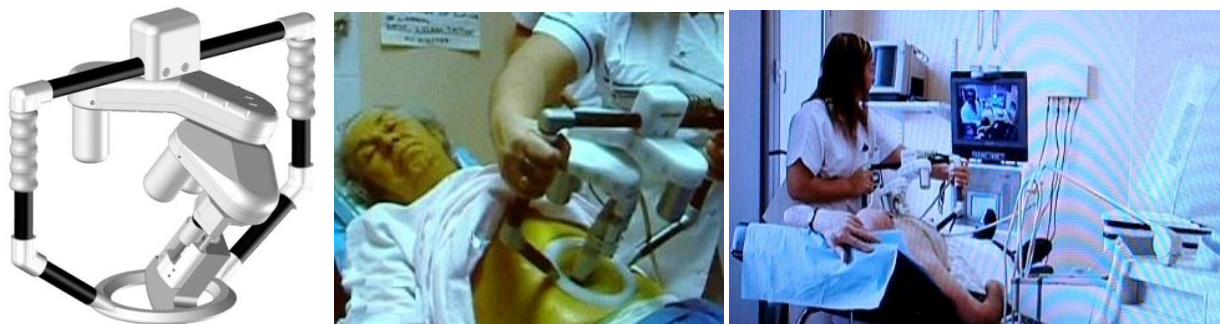
Рисунок 3.10. Роботизированный прибор для дистанционного проведения ультразвуковых исследований. Синхронная телемедицинская консультация с применением роботизированного УЗИ-сканера, дистанционное управление диагностическим прибором 33
