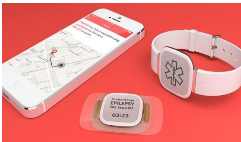
Рисунок 3.22. Портативный комплекс персональных устройств: мобильное устройство связи, специальная прикладная программа (мобильное приложение), носимые устройства (датчики в виде браслета и пластыря) 45
