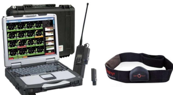
Рисунок 10.4. Военная телеметрическая система: набор датчиков, пояс для крепления датчиков, прибор исследователя (командира) и радио-устройство. На экране графически отражается состояние физиологических функций каждого мониторируемого военнослужащего 207
