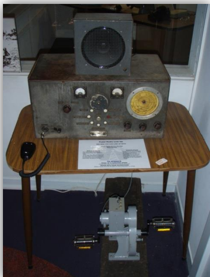
Рисунок 3.1.7. Педальная радиостанция Авиационной медицинской службы (использовалась для радио телеконсультаций), Австралия, 1930-е годы 26
