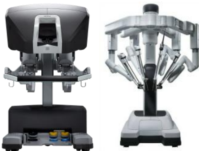
Рисунок 9.5. Master- и slave-компоненты активной инвазивной (телехирургической) системы телеассистирования 197
