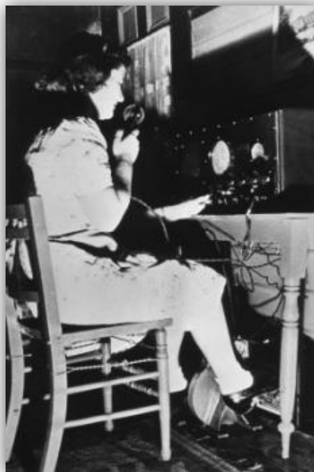
Рисунок 3.1.9. Типичный комплект «pedal radio» в сельском населенном пункте Австралии (автор фотографии Scott Weatherson)
