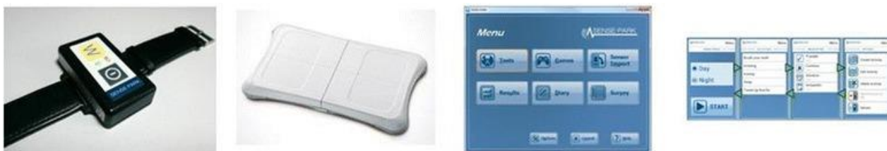
Рисунок 23.1. Компоненты пациент-центрической теленеврологической системы для пациентов с болезнью Паркинсона (носимое устройство – браслет, стабилметрическая платформа, специальное программное обеспечение, мобильное приложение) 432
