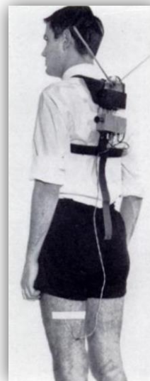
Рисунок 4.4.3.2. Биотелеметрическая электромиографическая система для изучения физиологии ходьбы (Великобритания, 1967 г.) [49]
