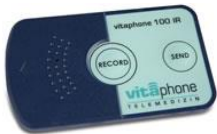
Рисунок 22.1. Персональный прибор для съема ЭКГ в 1 отведении (для фиксации ЭКГ в 1 отведении достаточно приложить прибор к грудной клетке в нужной точке) 395
