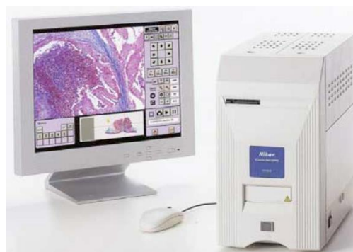
Рисунок 17.6. Система для активной динамической телепатологии (роботизированный микроскоп)
