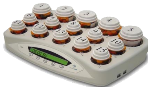
Рисунок 22.2. Прибор для управления (медикаменты рассортированы по контейнерам; согласно программе прибор извещает пациента о необходимости приема нужного количества таблеток из нужного контейнера) и контроля (если пациент многократно пропустил прием медикаментов прибор автоматически извещает call-центр о возможной недееспособности подопечного) 396
