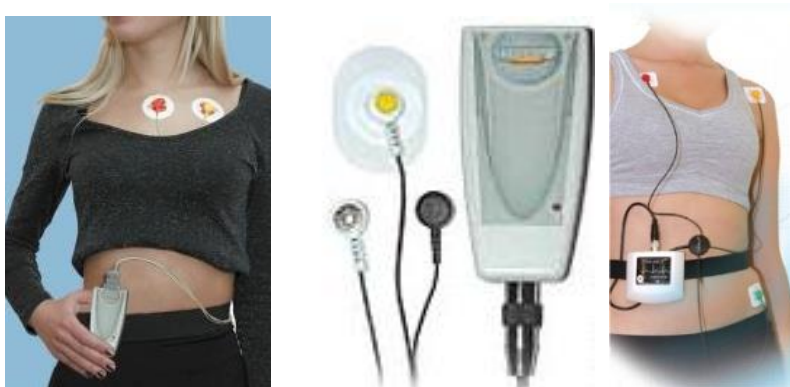
Рисунок 13.5. «Прибор пациента», передающее устройства комплекса радиомониторного ЭКГ-контроля 251
