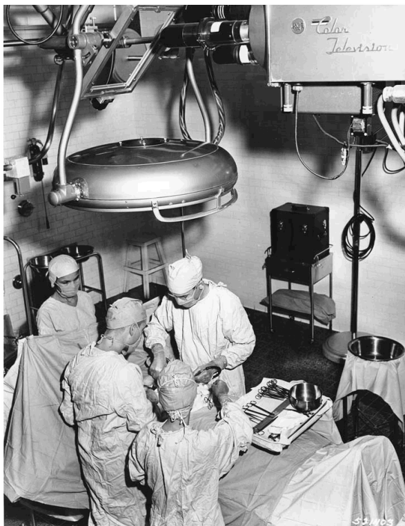
Рисунок 4.2.1.42. Цветная телевизионная установка в операционной армейской больницы Уолтер Рид (оснащена набором линз, направлена на поверхность зеркала, в котором отражается операционное поле). Дата фотосъемки 14.11.1957. Фотография из коллекции National Archives and Records Administration, SC 521403 [55]
