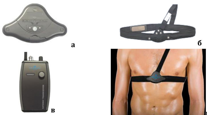
Рисунок 10.1. Универсальная телеметрическая система: а- датчик, б- пояс для крепления дополнительных датчиков и передающего устройства, в - передающее радио-устройство, г - фиксация датчика на теле 204
