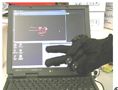
Рисунок 25.8. Электронная сенсорная перчатка для телереабилитации пациентов с последствиями травм и заболеваний кисти, нарушениями двигательных функций: а - общий вид, б - отслеживание движений и создание 3D модели кисти 469
