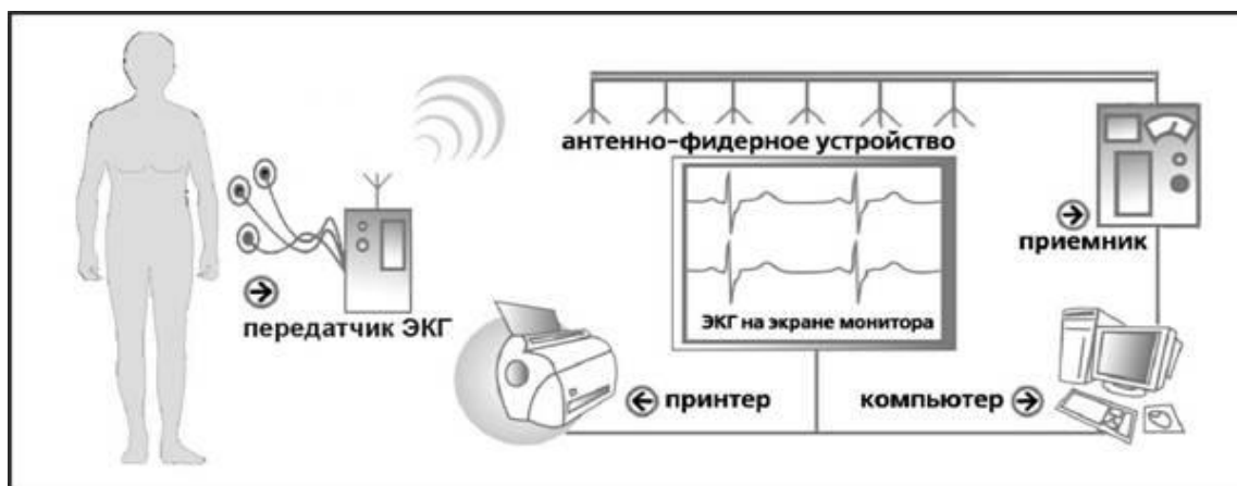
Рисунок 13.4. Принципиальная схема клинической биорадиотелеметрической системы 250
