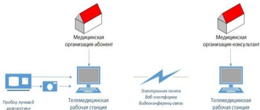
Рисунок 18.1. Организация телерадиологической сети: абонент выборочно производит оцифровку диагностической визуализации и передачу/трансляцию файлов эксперту посредством стандартных инструментов телеконсультирования; интерпретация изображений производится по запросу
