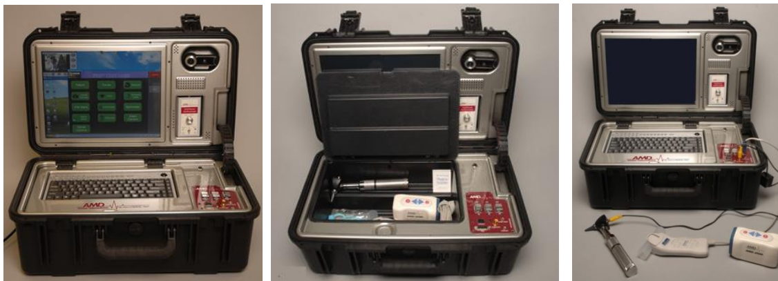
Рисунок 7.8. Мобильный телемедицинский комплекс, который содержит электронную медицинскую карту пациента, программные средства видеоконференцсвязи, телемедицинскую камеру, для общего обследования, 12-канальное ЭКГ-телеметрическое устройство, диагностическое оборудование с телемедицинскими функциями – цифровой отоскоп, цифровой спирометр, цифровой стетоскоп 182
