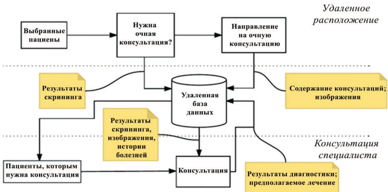
Рис. 1. Блок-схема, демонстрирующая принцип работы платформы MicroG eHealth
