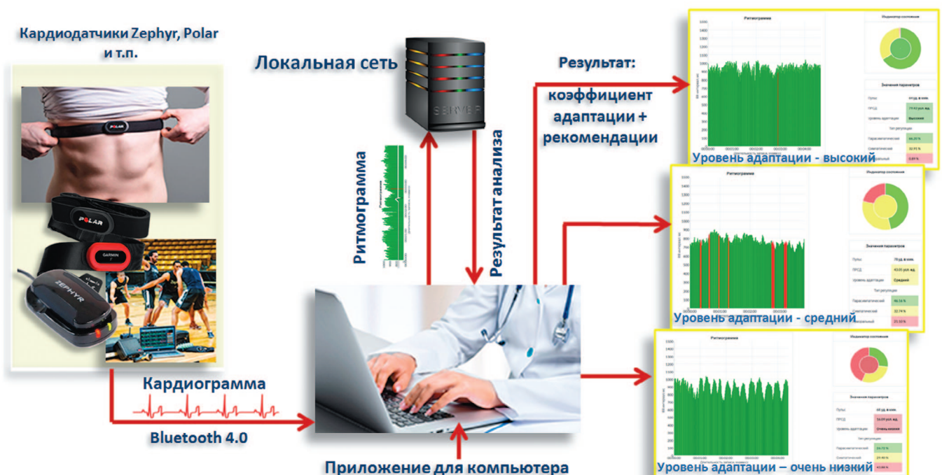
Рис. 2. Схема взаимодействия программы RR Viewer в режиме off-line Fig. 2. Scheme of interaction of the RR Viewer program in off-line mode
