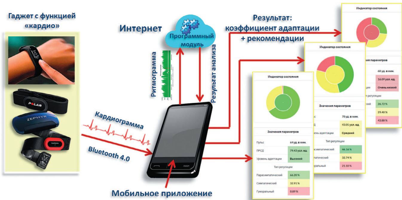
Рис. 1. Схема взаимодействия программы RR Viewer в режиме on-line Fig. 1. Scheme of interaction of the RR Viewer program in on-line mode
