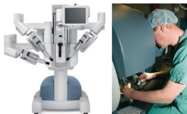
Рис. 2. Slave-компонент активной инвазивной (телехирургической) системы телеассистирования. Master-компонент (хирургическая консоль) активной инвазивной (телехирургической) системы телеассистирования
