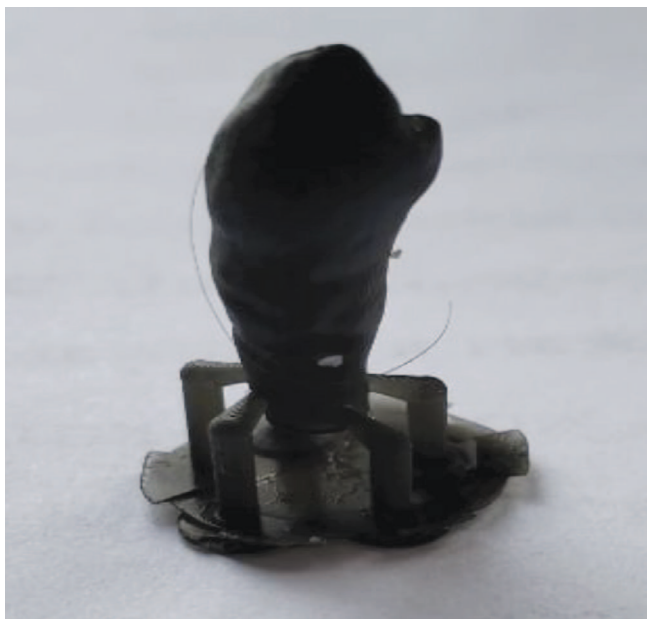
Рис. 1. Напечатанная персонализированная 3D-модель зуба Fig. 1. Printed personalized 3D tooth model
